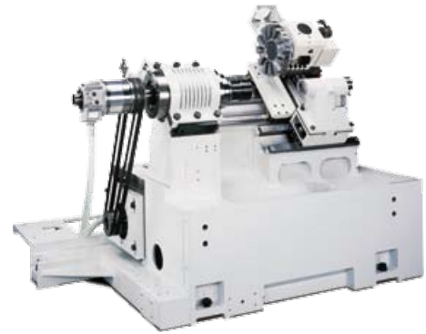
در تصویر بدنه دستگاه تراش فاراکس T16 به نمایش در آمده است. این طرح با بدنه مورب ۴۵ درجه دقت بالا و کیفیت ماشینکاری را تضمین می نماید
