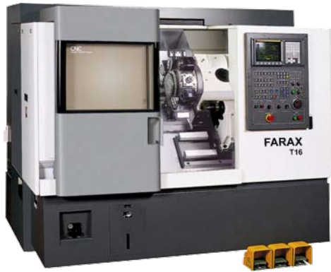
دستگاه تراش فاراکس T16 با تارت سروو موتوری با ابزارهای دوار و کنترلر موتور و درایوهای دیجیتال فانوک
