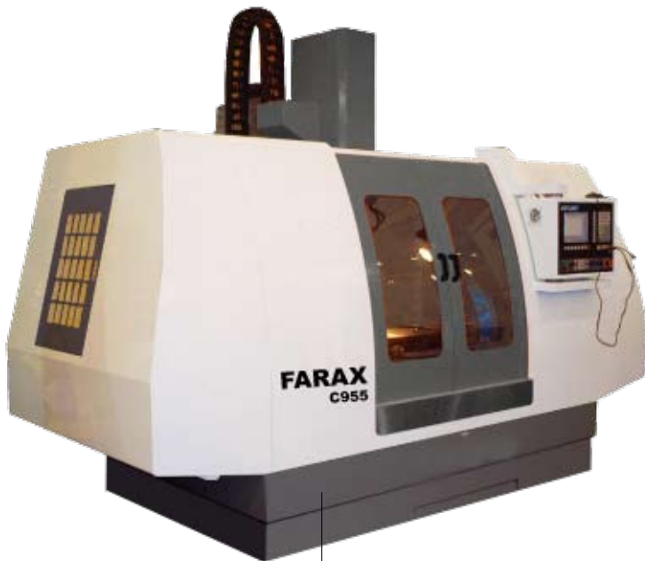
دستگاه فاراکس C955 با کنترلر PA8000 و نمایشگر ۱۲ اینچ LCD با گارد محافظ دستگاه به نمایش در آمده است
